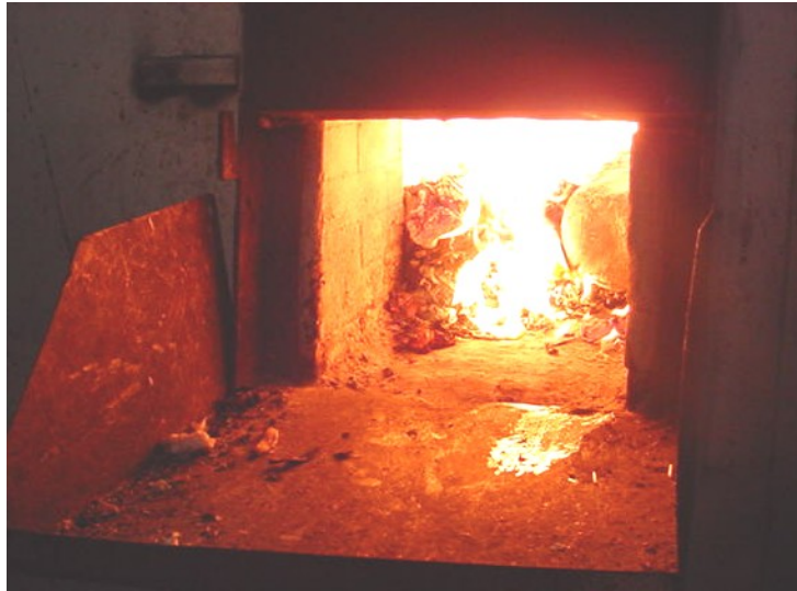
FIGURA 36. Processo de tratamento por incineração a uma temperatura de 900 °C a 1000 °C.
