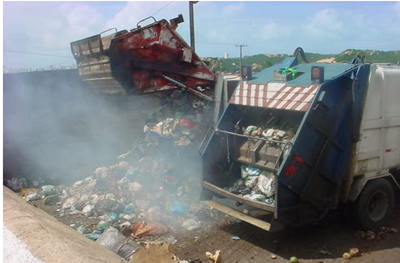
FIGURA 29. Descarrego dos resíduos na área de transferência.
