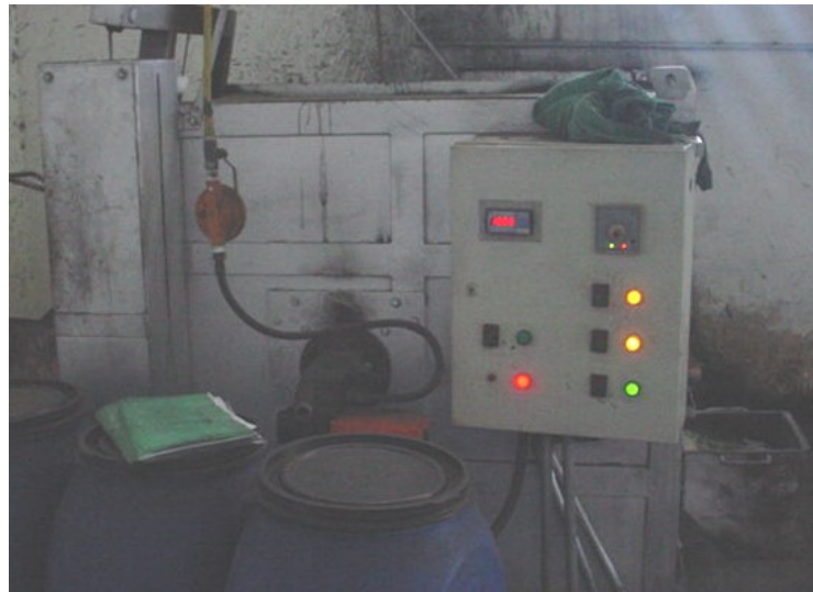
FIGURA 35. Processo de tratamento por incineração a uma temperatura de 900 °C a 1000 °C.
