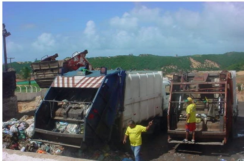
FIGURA 30. Descarrego dos resíduos na área de transferência.
