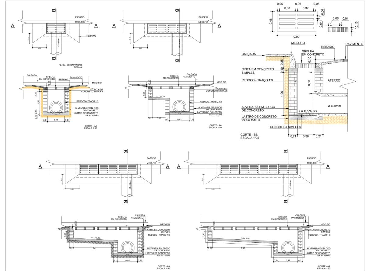
**DESCIDAS D'ÁGUA DE ATERROS EM DEGRAUS - DAD**
