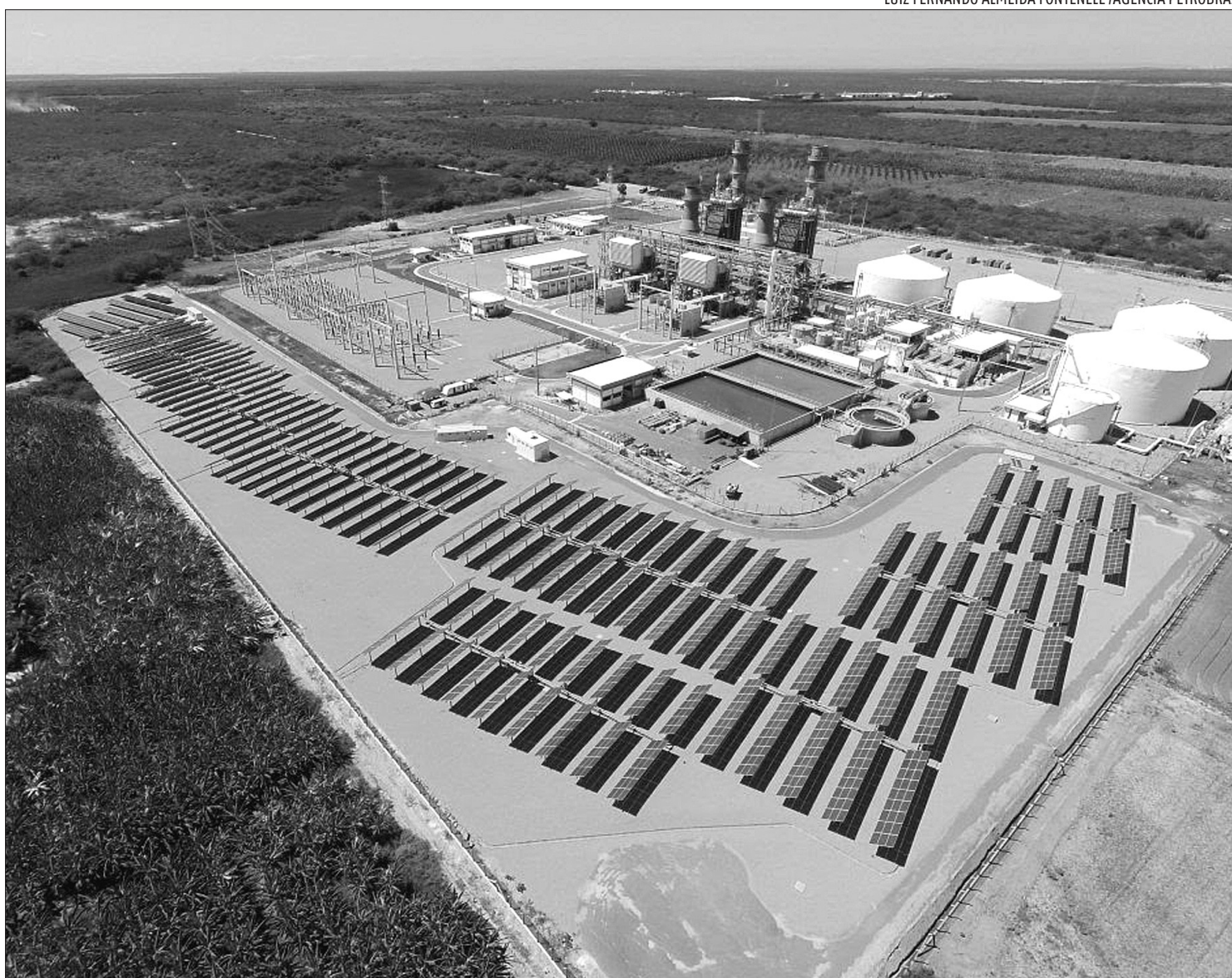
Usina Fotovoltaica de Alto do Rodrigues será ampliada de 1,0 MWp para 2,5 MWp para suprir a demanda elétrica do projeto piloto
